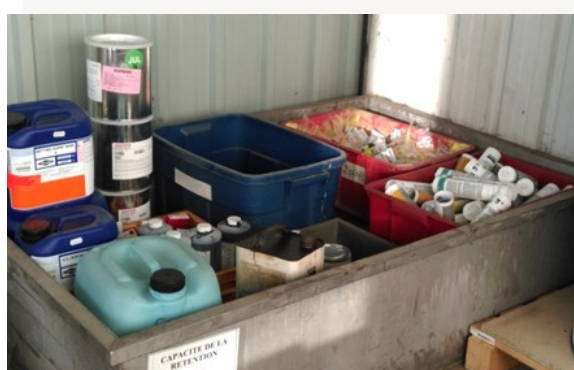
Exemple de stockage sur rétention d'aérosols et d'emballages de produits
